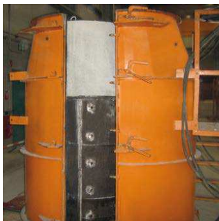
Het kegelopzetstuk wordt in verschillende standaard hoogtes geproduceerd.
